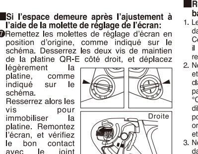
**Réparation de la base QR-E et réglage de l'écran de la CWR-1/CWR-F**
