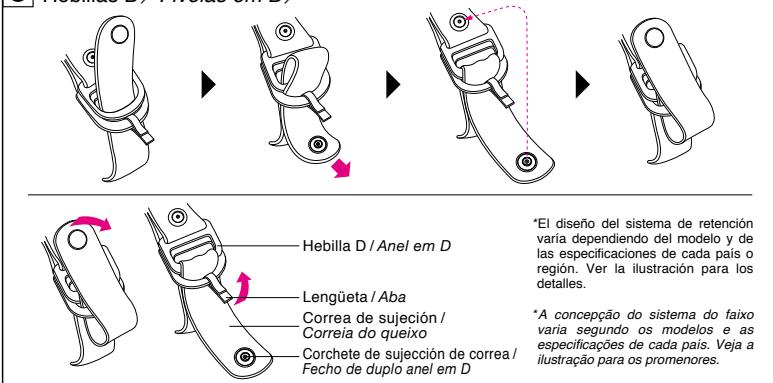
**Sistema de Cierre rápido:** Para abrochar la correa, presionar la lengüeta metálica (b) firmemente en el soporte como se muestra en el diagrama (C) hasta notar un clic. Tirar de la correa y pasar el extremo a través del aro textil o de piel para asegurarla. Para desabrochar la correa, presionar las dos partes (a) hacia el interior como se muestra en el dibujo.
