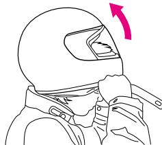
Lösen Sie zunächst den Kinnriemen und halten die zwei Kinnriemenenden mit beiden Händen fest. Ziehen Sie die beiden Kinnriemenenden nach außen und ziehen den Helm nach hinten von Ihrem Kopf, wie in der Zeichnung gezeigt.
