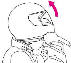
En primer lugar, extraiga un barboquejo, y sujeté los barboquejos con ambas manos. Sujetando los barboquejos, separe el casco y quitéselo de la cabeza desplazándolo hacia atrás tal y como se muestra en el dibujo.
