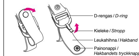
\*Kiinnitysmekanismin typpi vaihtelee riippuen kunkin maan tai alueen malleista ja määräyksistä. Katso yksityiskohdat kuvasta.
