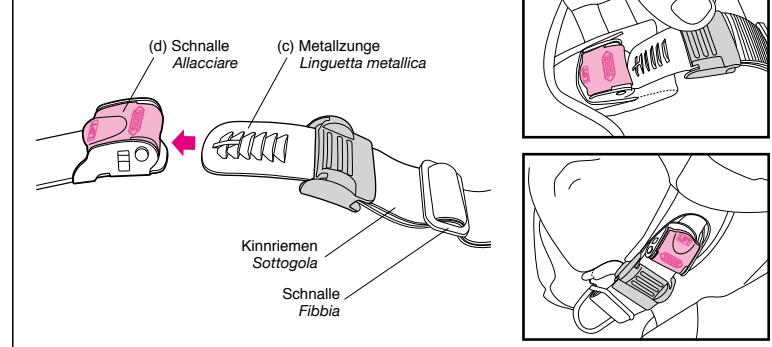
**Überprüfen Sie, dass der Kinnriemen gut sitzt und nicht locker ist:** Der Kinnriemen sollte so eng wie möglich anliegen, ohne Schmerzen zu verursachen. Der Gurt darf nicht durchhängen und muss eng an Ihrem Kinn anliegen. Bei korrekter Spannung im Kinnriemen ist ein normales Atmen und Schlucken möglich, es ist jedoch kein Finger breit Platz zwischen Kinnriemen und Hals.
